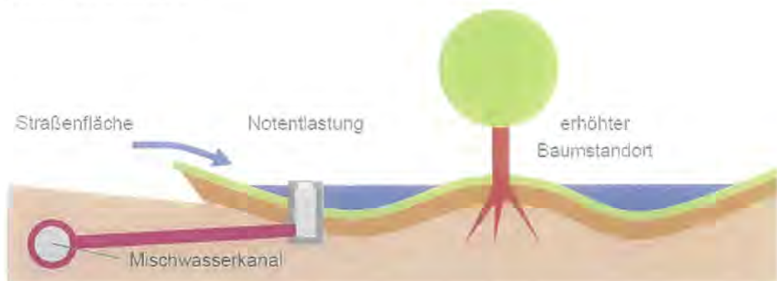
Abbildung 5: Schnitt Versickerungsmulde mit Baumstandort (Wald & Corbe 2014)
