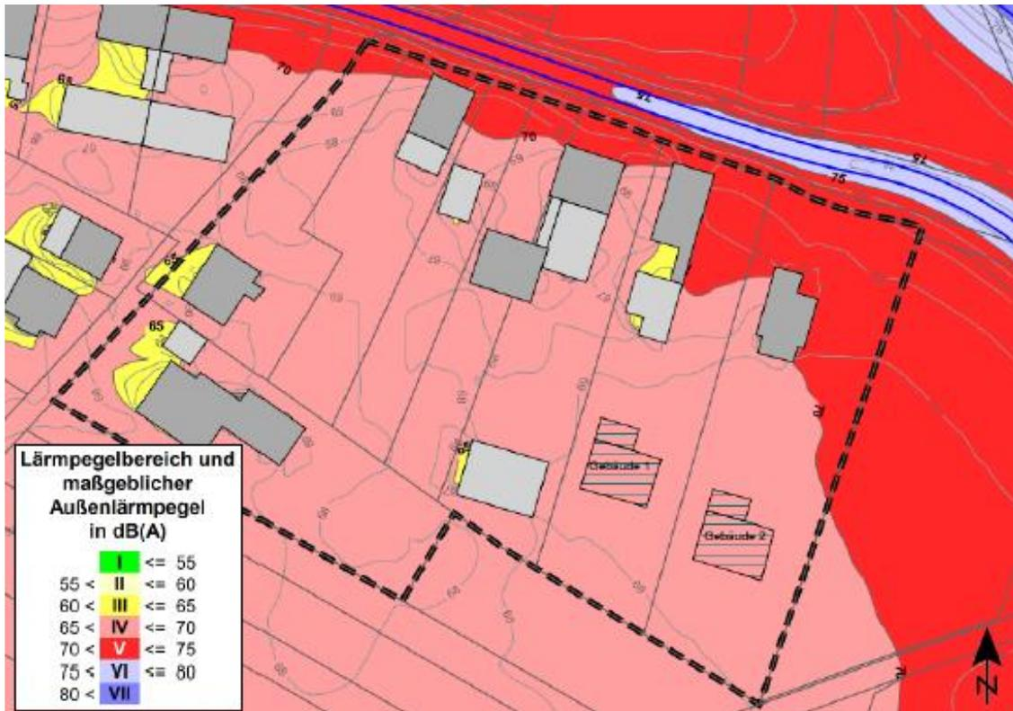
Abbildung – Kennzeichnung Lärmpegelbereiche nach DIN 4109, Rechenhöhe 2,4 m über Gelände
