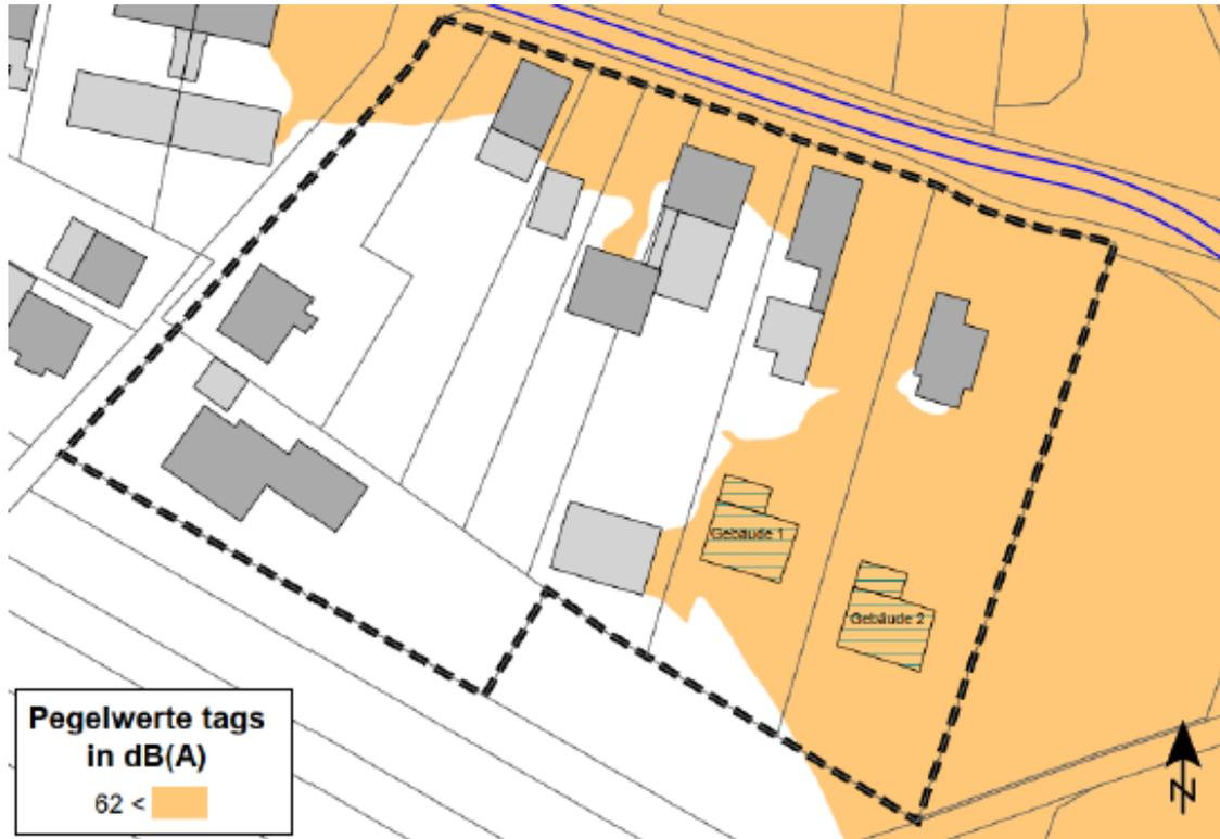
Abbildung – Kennzeichnung Schutz der Außenwohnbereiche (orange: Pegelwerte tags > 62 dB(A)), Rechenhöhe 2,4 m über Gelände
