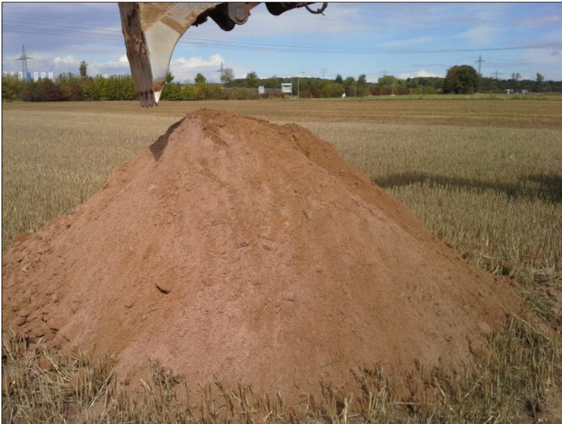
Abb. 5: Blick in Schurf S III, ab einer Tiefe von 2,0 m Mittelsand mit zu- nehmenden Grobsandanteil, feinkiesig
