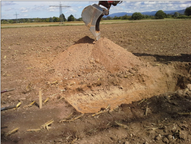
Abb. 8: Blick in Schurf S 8, Oberkante der Kinzigsschotter liegt bereits bei 0,6 m unter Gelände
