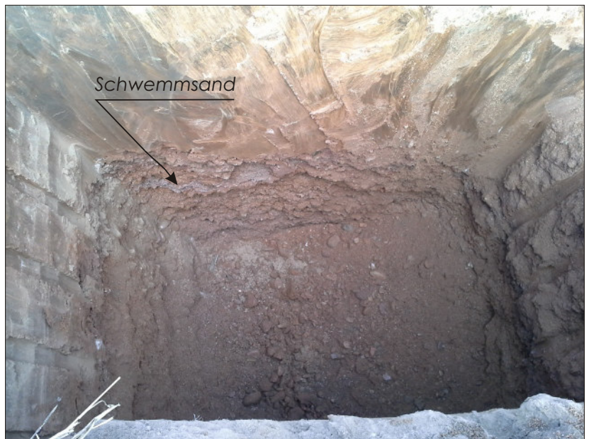
Abb. 3: Detail Haufwerk des Schurfs S V, Decklehm aus nahezu kohäsionslosen Schluff (Schwemmlöss)
