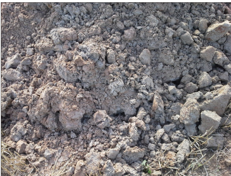
Abb. 3: Detail Haufwerk des Schurfs S V, Decklehm aus nahezu kohäsionslosen Schluff (Schwemmlöss)
