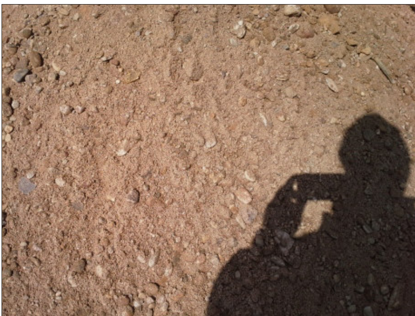
Abb. 9: Detail der oberflächennahen Kinzigsschotter. Hier als stark sandige fein -/mittelkiesiger Schotter ausge- bildet
