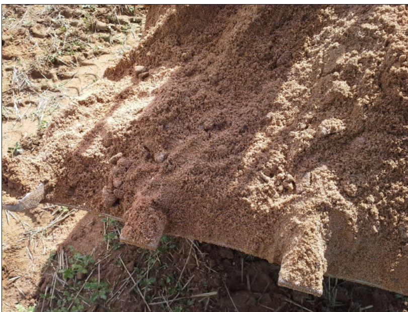
Abb. 6: Detail Schwemmsand aus der Basis von S III, Mittel-/Grobsand, feinkiesig
