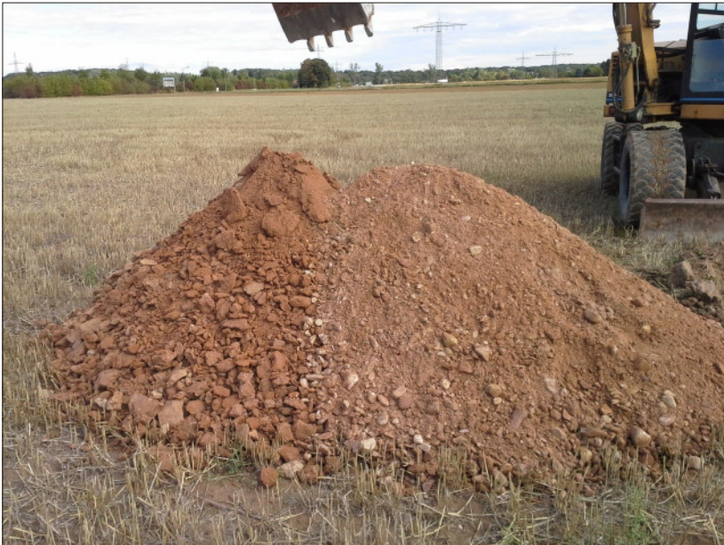
Abb. 2: Blick in Schurf S IV, schwach toniger Auelehm unterlagert von Kinzigschotter. Schwemmsand lediglich als unterbrochene wenige Zentimeter starke Einschaltung ausgebildet
