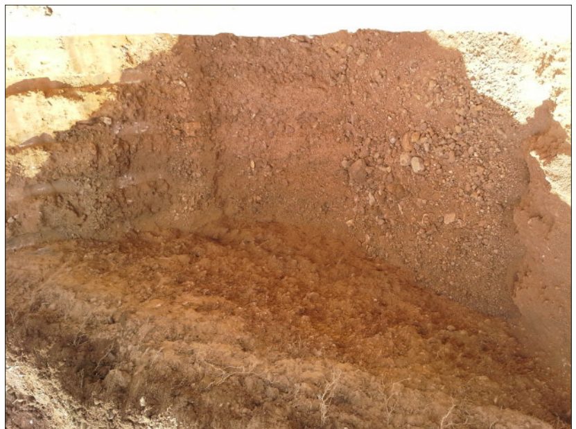
Abb. 9: Detail der oberflächennahen Kinzigsschotter. Hier als stark sandige fein -/mittelkiesiger Schotter ausge- bildet
