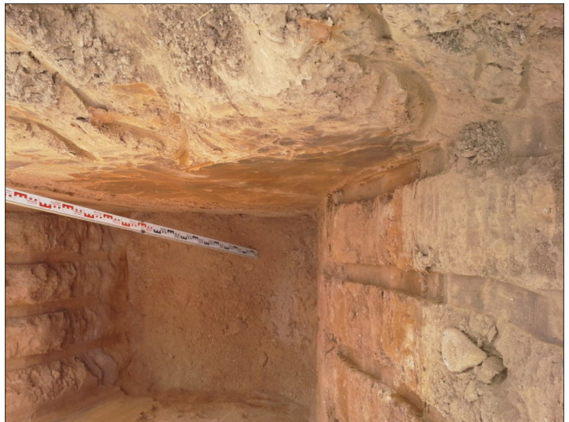
Abb. 6: Detail Schwemmsand aus der Basis von S III, Mittel-/Grobsand, feinkiesig
